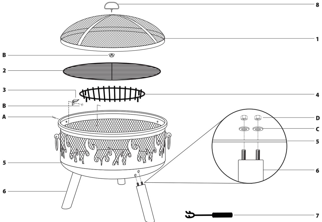
**SCHRITT 1 - Befestigen Sie 3 x Beine (6) an der Außenseite der Feuerstelle (5), indem Sie die befestigten Schraubgewinde durch die unteren Löcher in der Feuerschale (5) führen. Befestigen Sie nun jedes Schraubgewinde mit 1 x Unterlegscheibe (C) und 1 x Mutter (D).**
