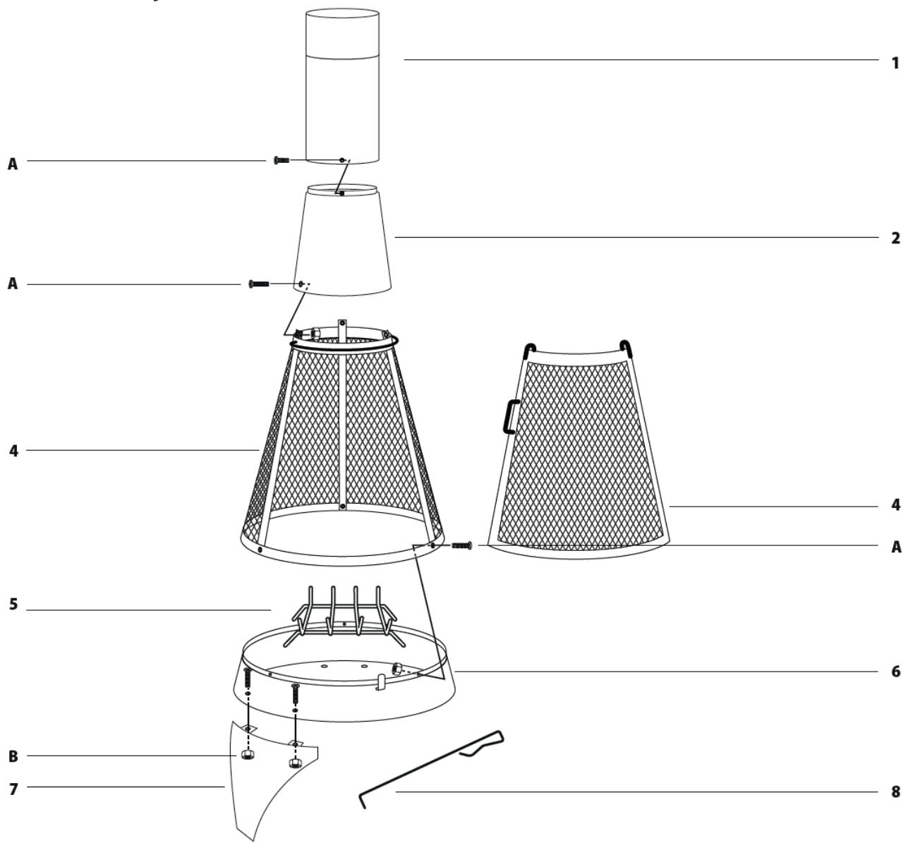
**PASO 1** - Conecte la chimenea (3) con el tiro inferior (2). Utilice para ello 3 tornillos (A) y 3 tuercas (B)
